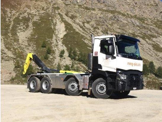
Renault C520 8x4 LSVA mit Partikelfilter
